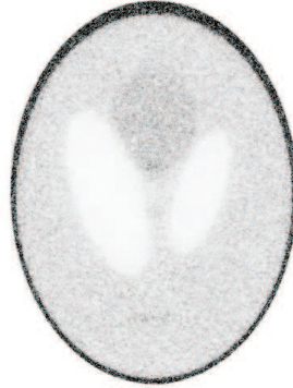
Figura 8: Reconstrução do Phantom de Shepp-Logan com apenas uma iteração de RAMLA
