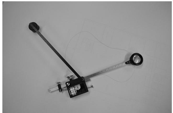
Figura 1: Foto de um planímetro de Amsler.
